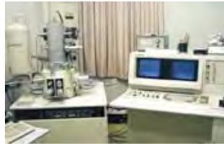
▲走査型電子顕微鏡装置外観
